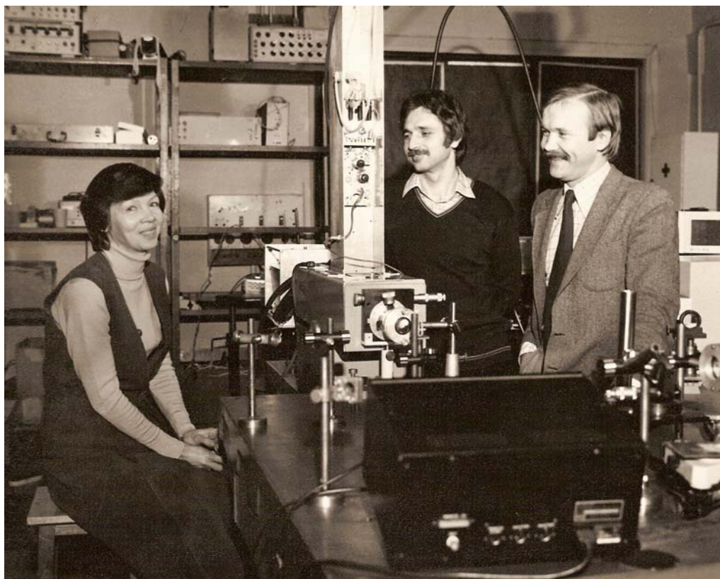
Joonis 3. Pikosekundilise spektrokronograafi keskne seade - elektron-optiline muundur koos lampelektronikal põhineva laotusseadega (vertikaalne ehitus), mis sellisel kujul töötab tänaseni. Hetke anno 1983 naudivad (vasakult lugedes) fotosünteesiliste bakterite "maaletooja" Valentina I. Godik, teadur Kõu Timpmann ja füüsikainstituudi teadusdirektor Arvi Freiberg. (K. Vestre foto.)
